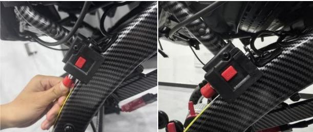
Veillez verrouiller d'abord les boucles de sécurité sur les côtés gauche et droit du cadre !
